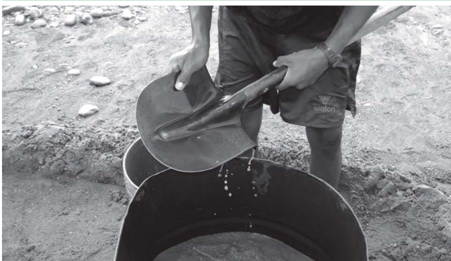
Arenilla negra depositada en cilindro. Preparando el lavado del material.
