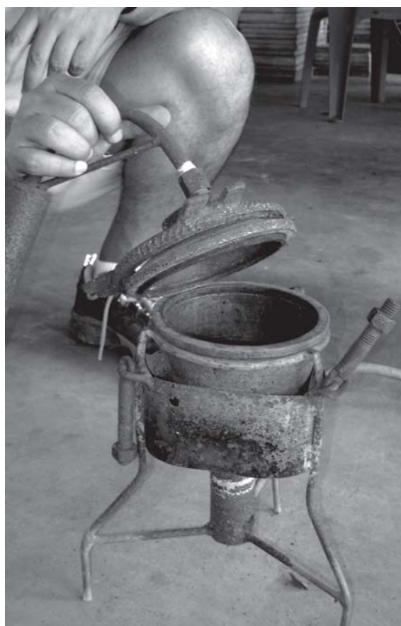
Modelo de retorta para su uso en proceso de amalgamación
