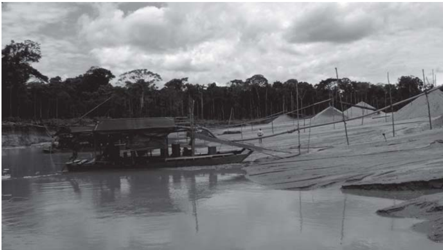
Método de balsa gringo.
