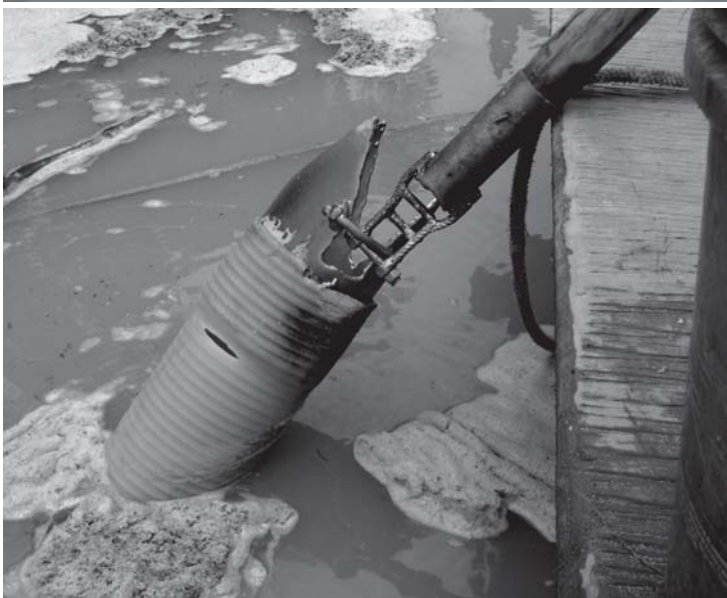
Método de explotación Balga-gringo. Se aprecia el "gringo" formado por la manguera de succión con la armazón de metal en forma de corona, y el palo.
