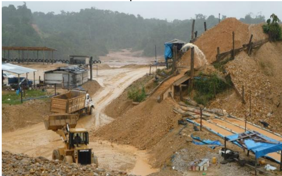
Figura 31 Lavado de Oro por Chuteo Huepetuhe 2010
